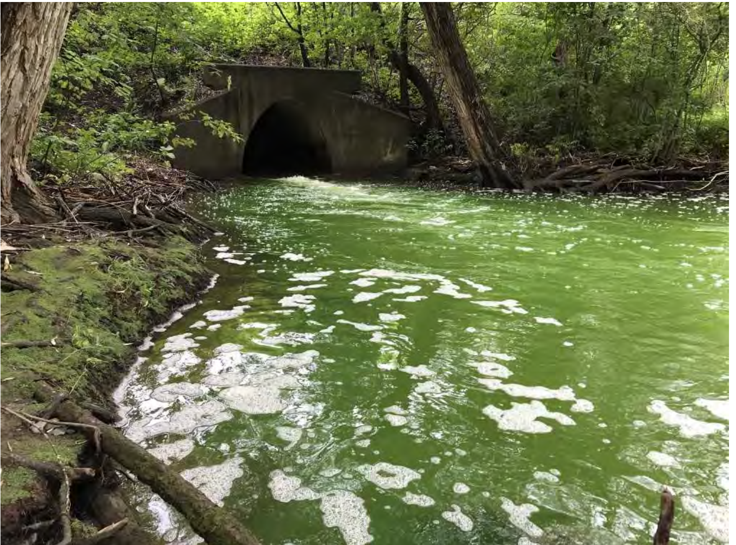
IMG_0926.JPG Image 88: 15h07 - Vue rapprochée de l'exutoire du ruisseau de la Lowney. Présence de traceur fluo.
