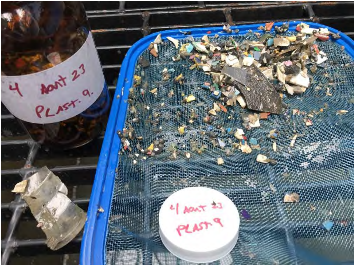
IMG_0871.JPG Image 49: 11h50 - Échantillon Plast-9. Particules de plastiques de produits bruts et de produits finis.
