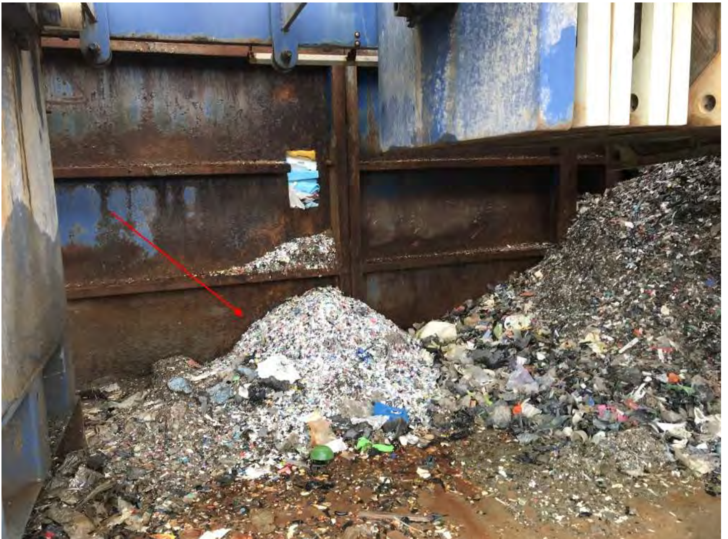
IMG_0820.JPG Image 2: 9h52 : À la gauche : Amas de produits brutes ayant subi un premier traitement. Échantillon Plast-2 - Point GPS 0077. À la droite : Amas de rejets provenant du convoyeur de l'autre côté du mur de métal.
