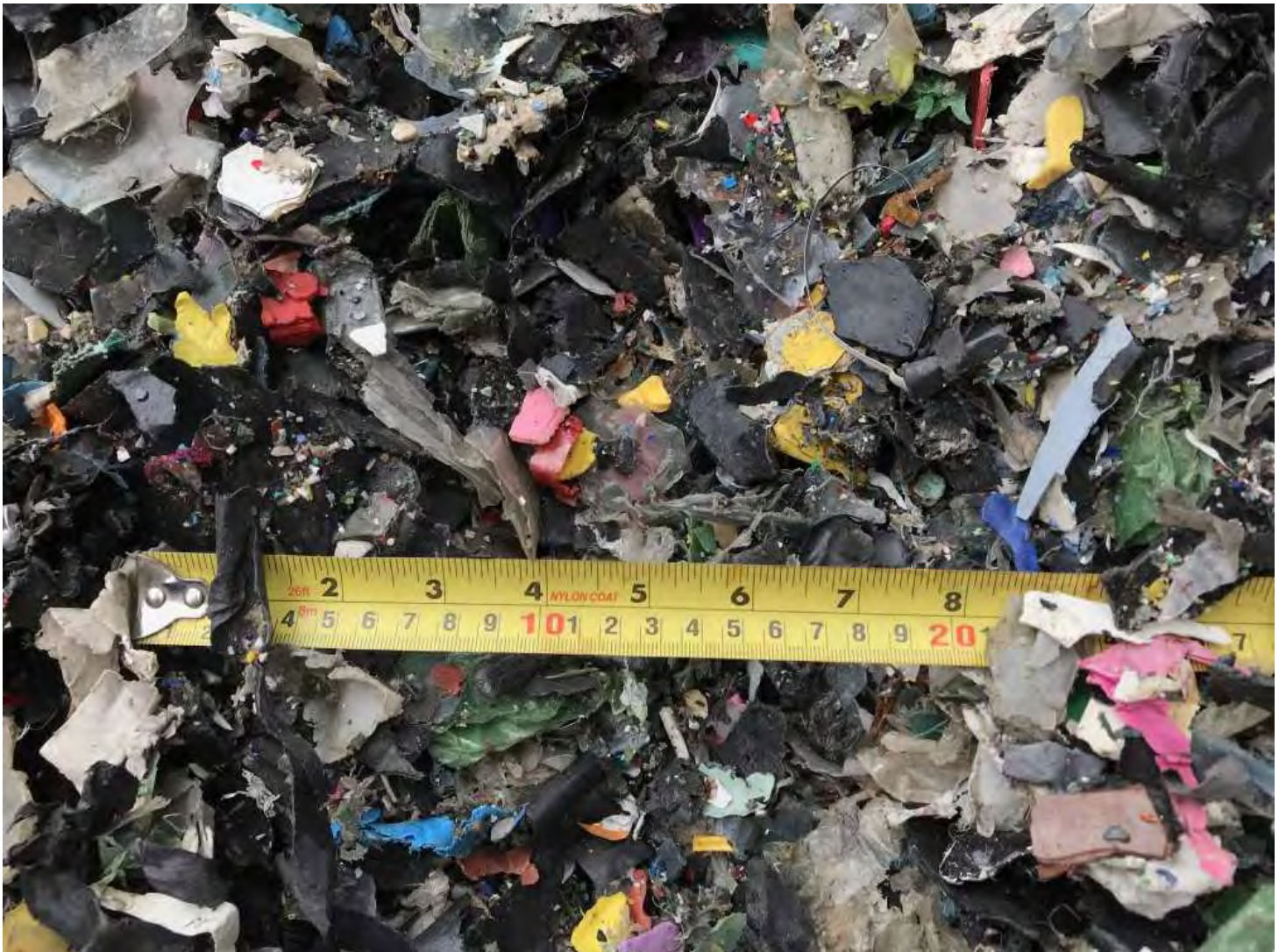
IMG_0824.JPG Image 6: 9h59 - Vue rapprochée des rejets dans l'amas. Mesure de la taille des rejets.
