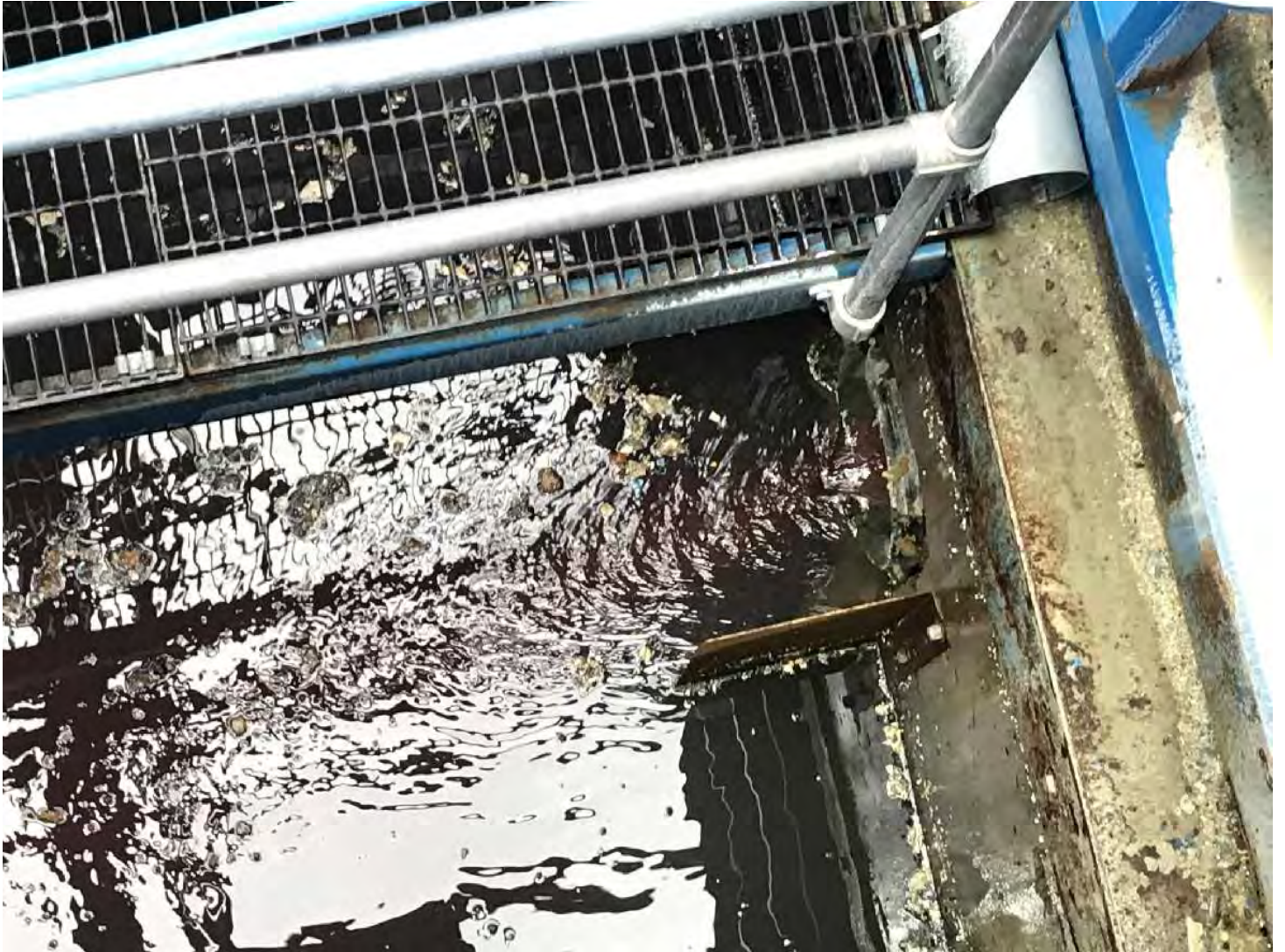
IMG_0878.JPG Image 53: 12h14 - Présence de traceur (rhodamine) dans le bassin de captation à 12h14.
