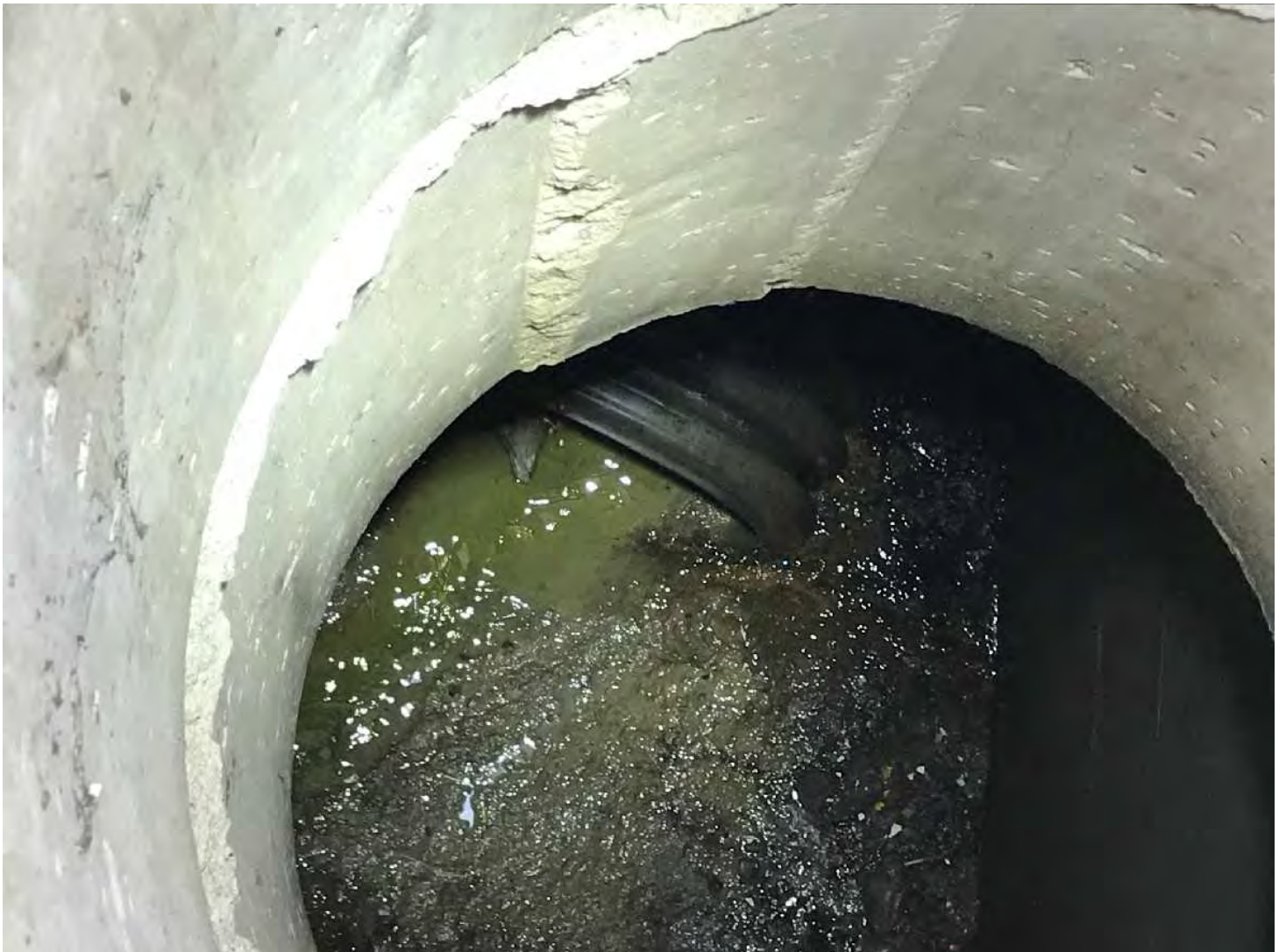
IMG_0885.JPG Image 56: 13h01 - Vue dans le regard chez Plastimum après injection de fluorescéine dans le bassin de captation. Présence de fluorescéine dans l'eau.
