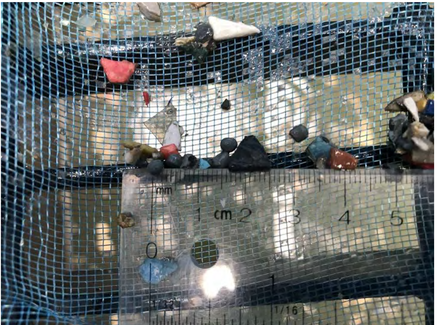
IMG_0874.JPG Image 52: 11h53 - Vue rapprochée et mesure des particules de plastiques retrouvées dans le bassin de captation.
