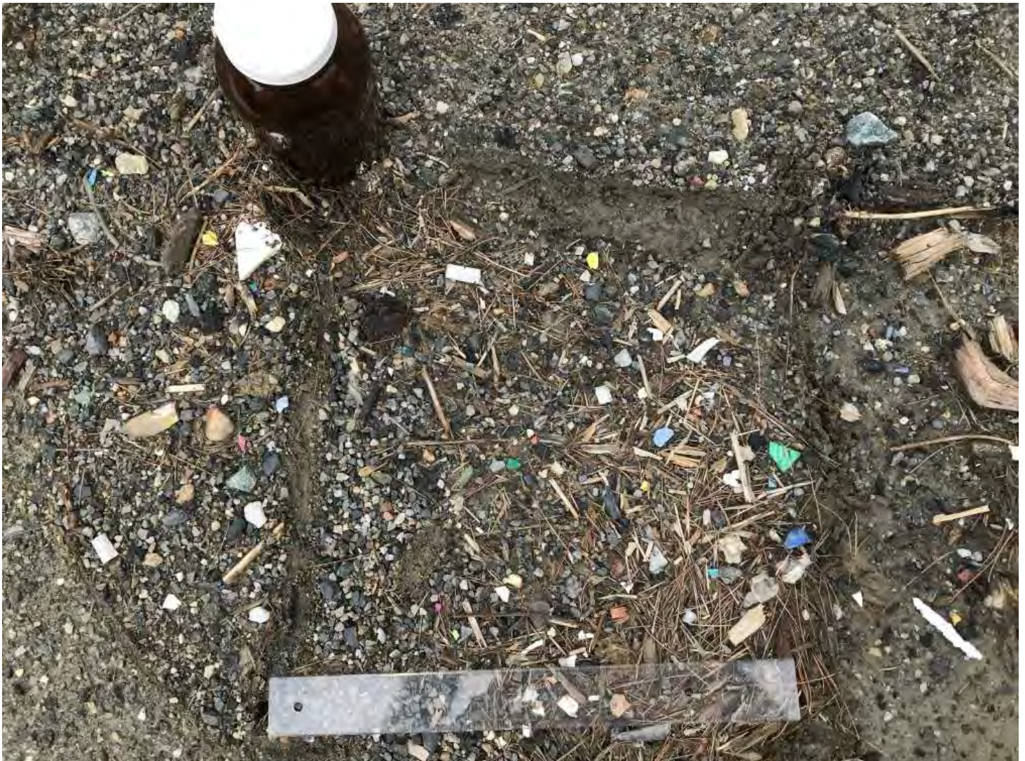
IMG_0795.JPG Image 22: Vue d'ensemble de la placette d'échantillonnage. 30cm x 30cm. Échantillonnage de surface.
