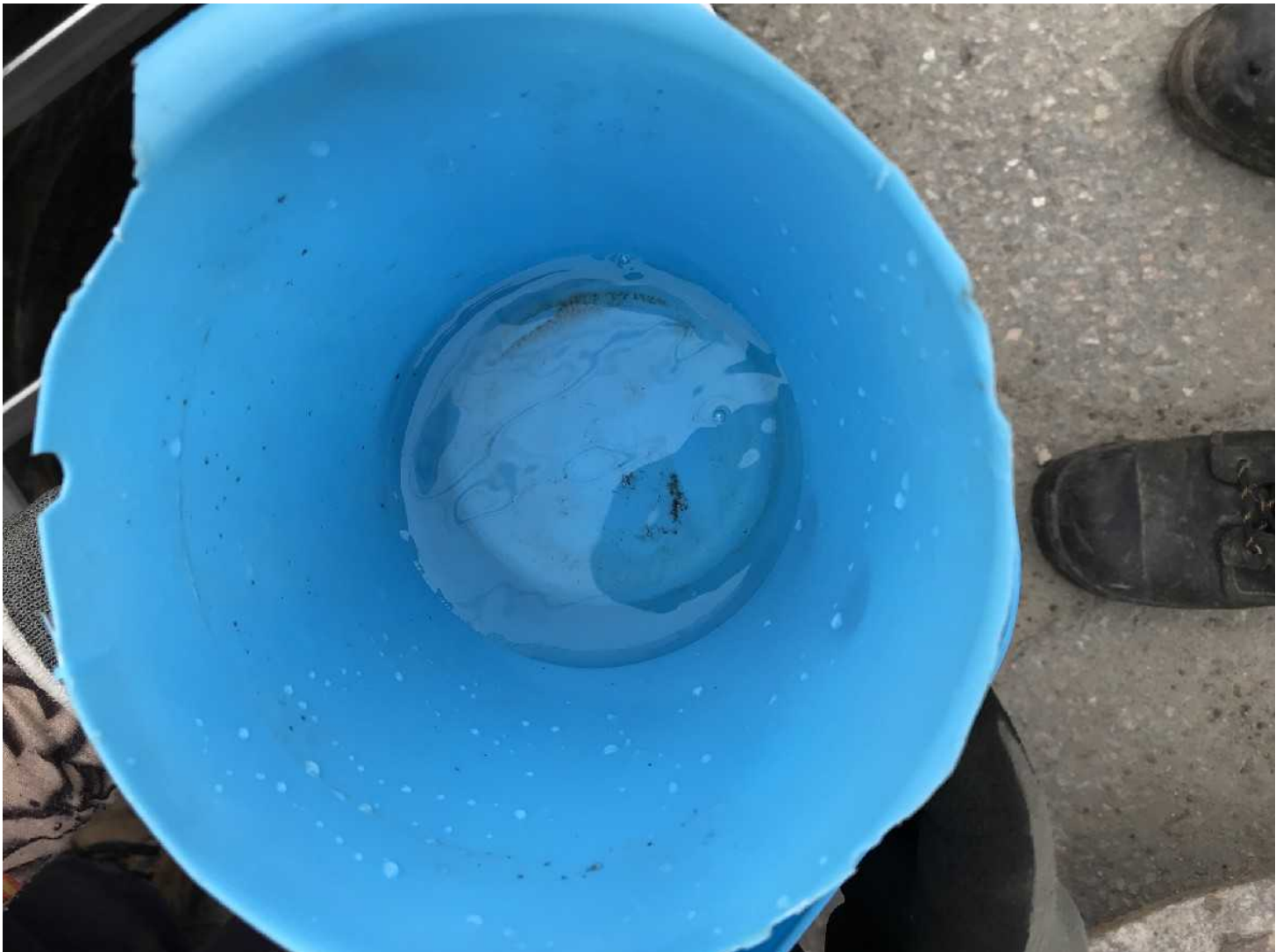
IMG_0732.JPG Image 2: Échantillon prélevé dans le réseau pluvial du trou d'homme en face du LEN. Absence de particules de plastique
