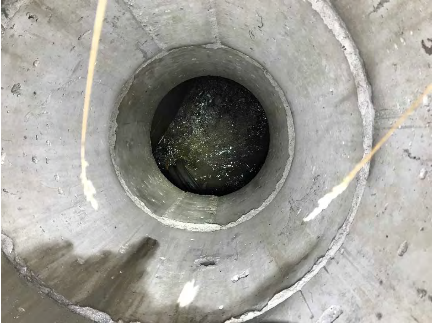
IMG_0883.JPG Image 55: 12h46 - Vue dans le regard chez Plastimum avant l'injection de fluorescéine. Absence de rhodamine.
