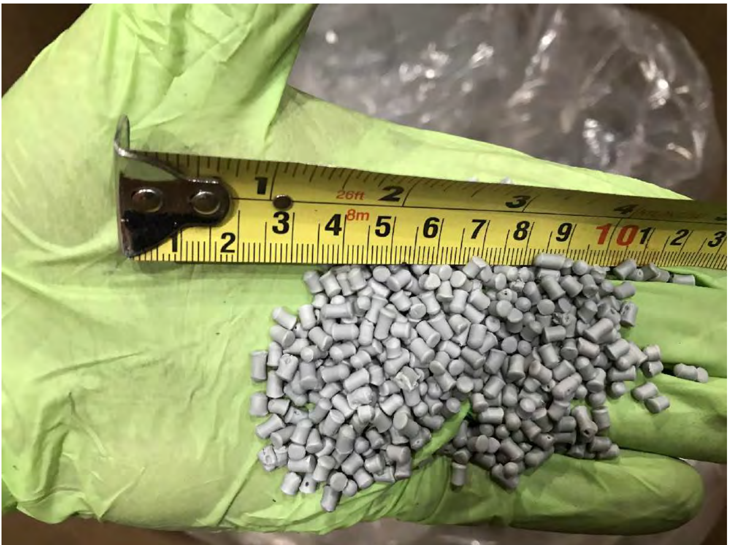
IMG_0864.JPG Image 4: Billes de plastiques gris pâle, produit fini. Mesure 4-5mm. Dans usine, section produit fini.
